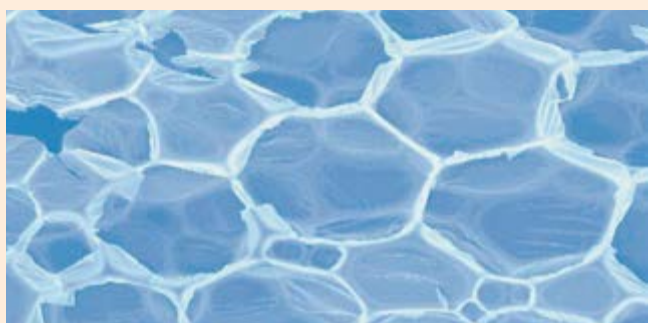
Blicke ins Innere des PU-Dämmstoffs: Milliarden winziger Zellen verhindern die Übertragung von Kälte oder Wärme.
